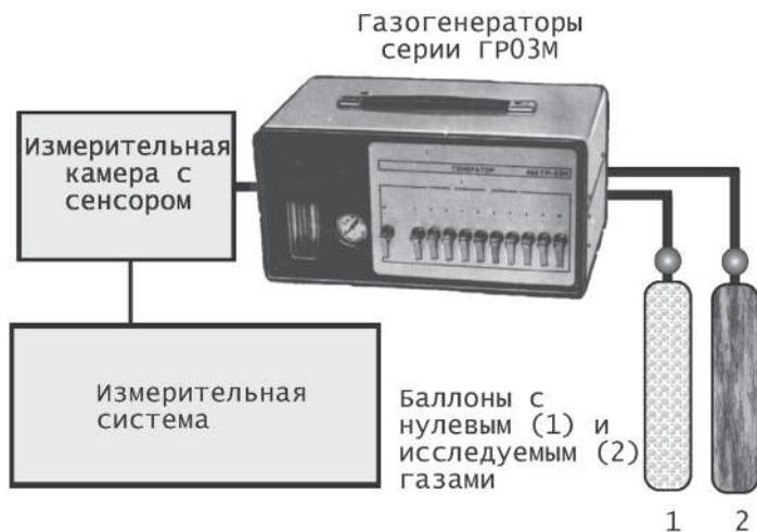
Рис. 1.8. Схема измерительного устройства для исследований влияния адсорбции газов на физические параметры полупроводников
